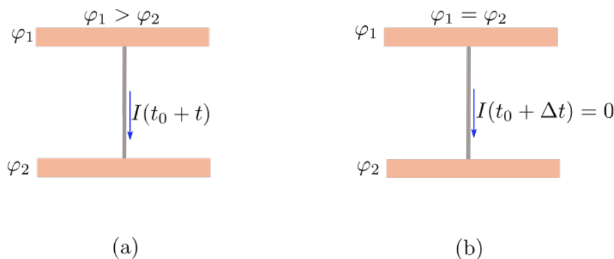
Obrázek 22.12: (a) Elektrický proud mezi dvěma vodiči o různých elektrických potenciálech. (b) Nulový proud mezi dvěma vodiči mající stejný elektrický potenciál.
